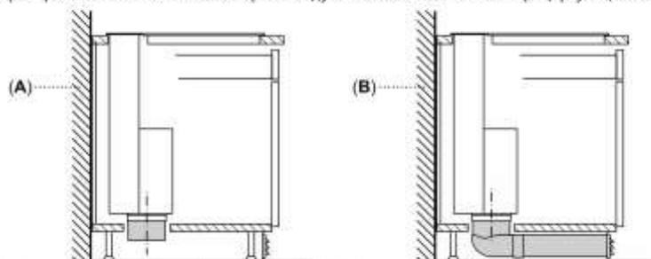
**A:** Външна стена – U стойност  $\leq 0,5 \text{ W}/(\text{m}^2\text{K})$
